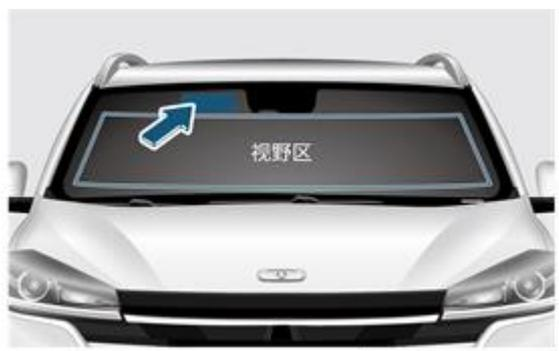
Внутри черной рамки стекла лобового стекла и область вне поля зрения может быть использована для установки автомобильных электронных знаков, рекомендуется устанавливать со стороны пассажира (область указания стрелок).
