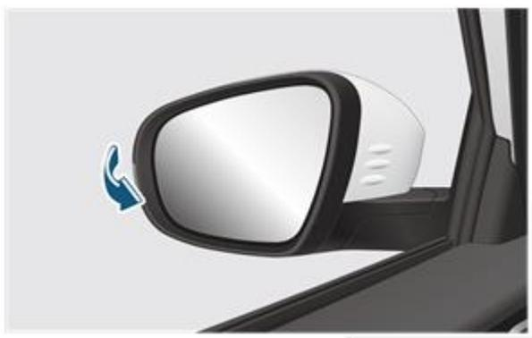
При необходимости корпус наружного зеркала можно сложить вручную. Отодвиньте наружные зеркала в сторону задней части автомобиля, сложив наружные зеркала.
