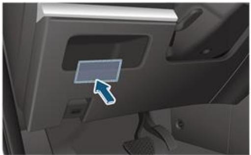
Электрический блок приборной панели расположен за нижней левой пластиной приборной панели, и предохранитель можно проверить и заменить, сняв нижнюю левую пластину приборной панели.
