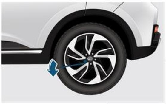
1. С помощью колесного ключа поверните колесный болт против часовой стрелки, ослабив его на один-два оборота.
