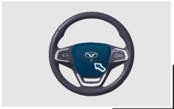
Автомобильные клаксоны используются для заблаговременного предупреждения на специальных участках дороги или при возникновении чрезвычайных ситуаций, чтобы обеспечить безопасность движения. Независимо от того, в каком состоянии находится источник питания, нажмите на идентификационную зону клаксона, расположенную на рулевом колесе, и прозвучит клаксон.
