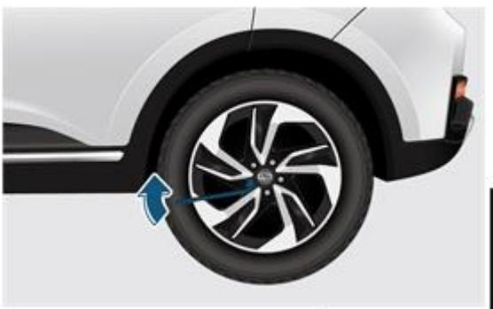
2. Установите домкрат в положение для поднятия кузова рядом с шиной, которую необходимо заменить, убедившись, что домкрат установлен на ровной и твердой поверхности.
