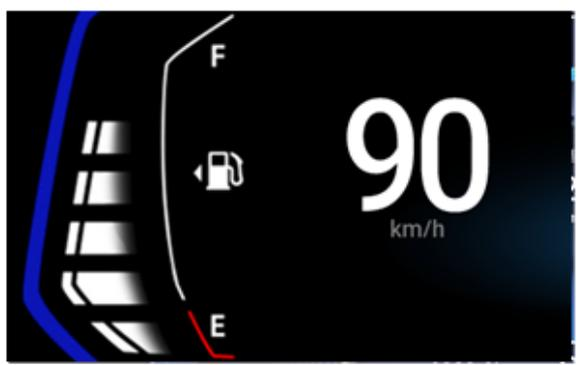
Спидометр используется для указания текущей скорости движения автомобиля в км/ч (километрах в час).
