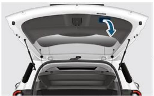
Потяните за ручку закрывания задней двери, чтобы опустить заднюю дверь вплотную к крышке заднего бампера, а затем сильно нажмите на нее обеими руками, чтобы закрыть.
