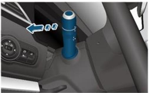
Когда ближний свет включен, переведите переключатель управления светом в крайнее положение в направлении от рулевого колеса, включится дальний свет, затем верните переключатель управления светом в исходное положение в направлении ближе к рулевому колесу, дальний свет выключится.
