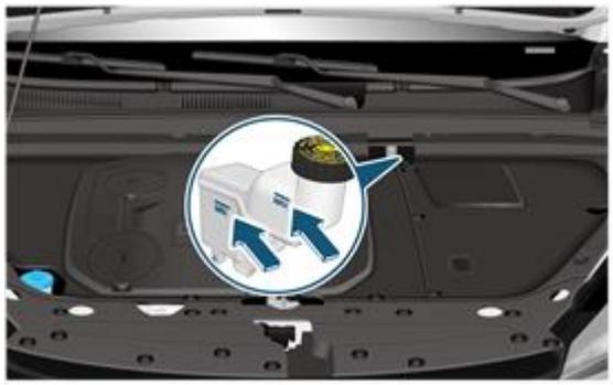
2. Проверьте, что уровень тормозной жидкости в баке тормозной жидкости находится в пределах линии боковой разметки:
