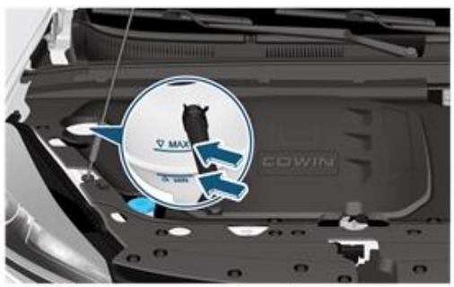
2. Убедитесь, что уровень охлаждающей жидкости в бачке охлаждающей жидкости находится в пределах линии боковой разметки:
