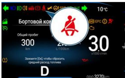
Автомобиль оборудован ремнем безопасности водителя без знака и зуммера, напоминающего водителю о необходимости пристегнуть ремень безопасности. Подробности смотрите в главе «Внутреннее Устройство и Эксплуатация - Приборы - Индикаторы Приборов». 24 страниц
