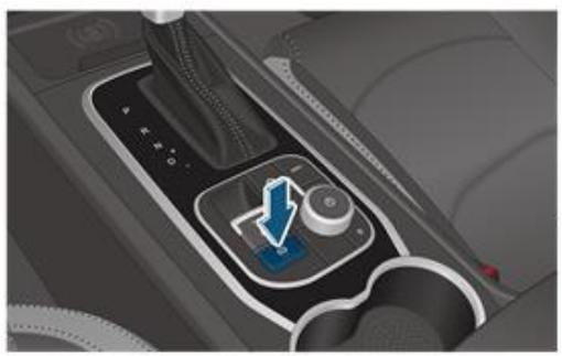
Когда условия запуска автоматической парковки выполнены, нажмите кнопку автоматической парковки, и загорится индикатор кнопки автоматической парковки, указывая на то, что автомобиль включил функцию автоматической парковки.
