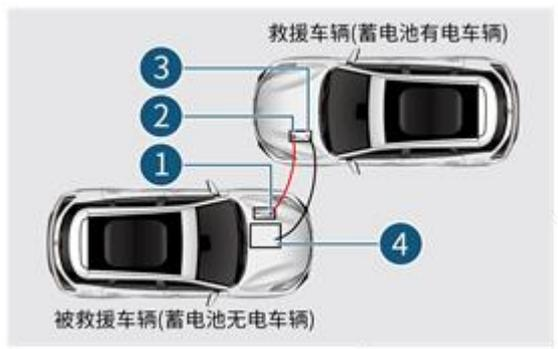
1. Подключите один конец красного положительного (+) кабеля к положительной (+) клемме **1** автомобиля без аккумулятора.
