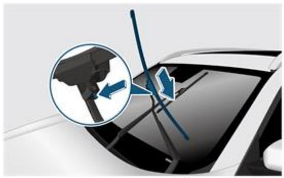
3. При нажатии на запирающую язычок потяните вниз переднюю щетку стеклоочистителя, чтобы снять ее.
