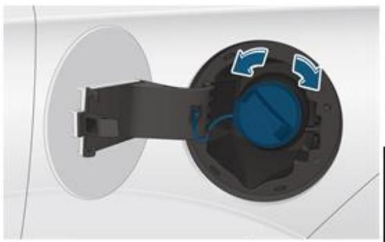
2. Медленно поворачивайте крышку наполнителя против часовой стрелки, снимите крышку наполнителя после откручивания.
