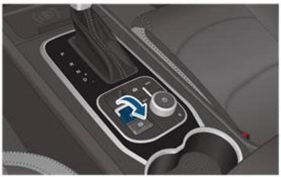
Когда источник питания всего автомобиля находится в состоянии «ON», когда автомобиль неподвижен и передача находится в положении «Р» или «N», потяните вверх электронную парковочную кнопку EPB, лампочка кнопки загорится, а индикатор стояночного тормоза (P) на приборе загорится, указывая на то, что электронный стояночный тормоз был задействован.
