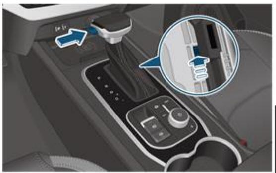
3. Переключите переключатель блокировки в направлении стрелки для разблокировки, одновременно нажимая кнопку разблокировки на боковой стороне рычага переключения передач, а затем переведите рычаг переключения передач из передачи «P» на передачу «N».
