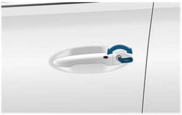
Вставьте механический ключ в скважину для ключа и поверните.
