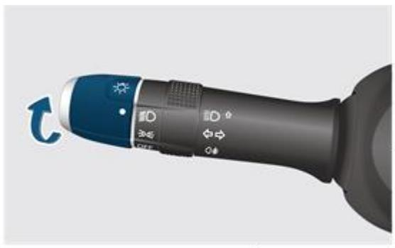
Источник питания всего автомобиля находится в состоянии «ON», поверните переключатель света в положение
