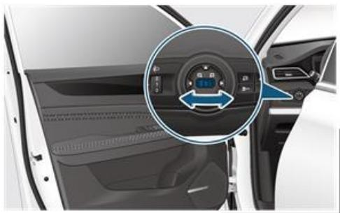
Перед началом движения автомобиля вы можете отрегулировать наружные зеркала на подходящий угол следующим образом.
