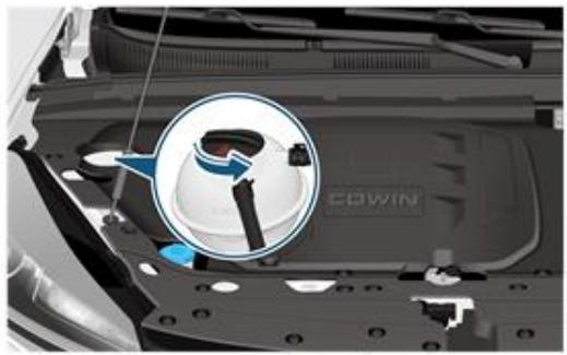
После проверки уровня охлаждающей жидкости, если вам необходимо добавить охлаждающую жидкость, вы можете выполнить следующие действия:
