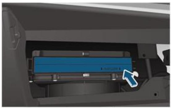
2. Нажмите на крышку фильтра кондиционера, чтобы зафиксировать пряжку, и снимите крышку фильтра кондиционера.
