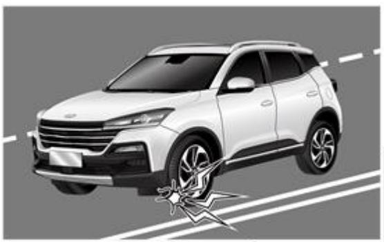
Во время движения автомобиля при возникновении прокола следует держать рулевое колесо обеими руками, изо всех сил стараться контролировать, чтобы рулевое колесо не вращалось само по себе, слегка нажать на педаль тормоза, снизить скорость и дать автомобилю двигаться по прямой в исходном направлении. Замена шин по мере необходимости после парковки.
