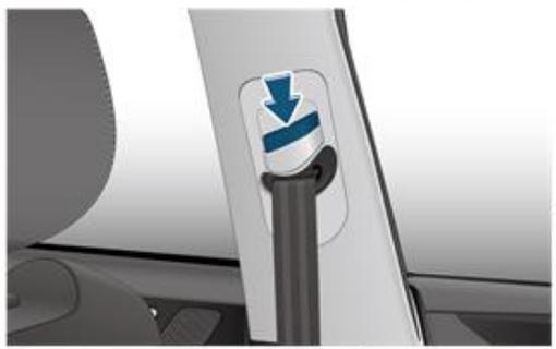
1. Ремень можно отрегулировать на соответствующую высоту, нажав кнопку регулировки регулятора высоты ремня, удерживая регулятор высоты и перемещая его вниз.
