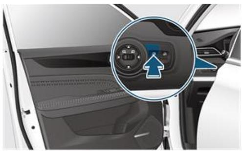
При необходимости наружные зеркала можно сложить с помощью кнопки складывания наружных зеркал.
