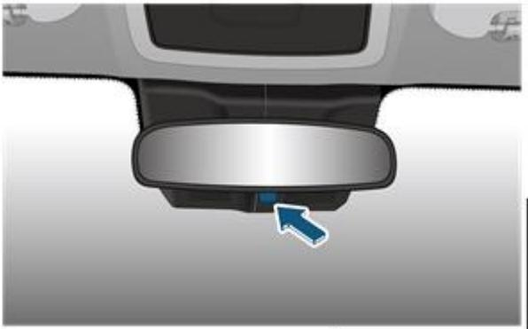
Если свет встречного автомобиля сзади слишком сильный, откинув ручку на нижнем конце внутреннего зеркала заднего вида, зеркало поворачивается под углом, чтобы предотвратить ослепление водителя.
