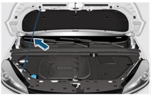
3. Поднимите передний люк, снимите опорную планку и крепко поддерживайте его.
