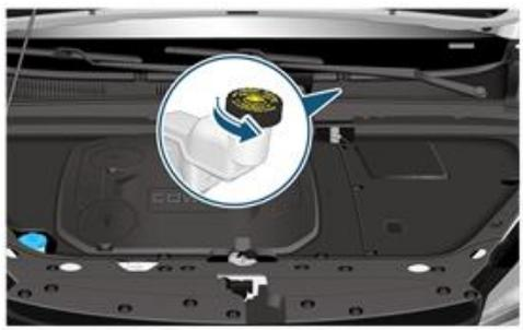
1. Когда двигатель холодный, открутите крышку бачка тормозной жидкости против часовой стрелки.
