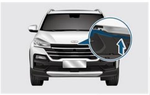
2. Протяните руку в центр передней части переднего люка, поднимите вверх ручку разблокировки вторичного замка переднего люка и одновременно поднимите передний люк вверх.
