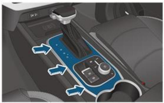
2. Осторожно поднимите панель рычага переключения передач.
