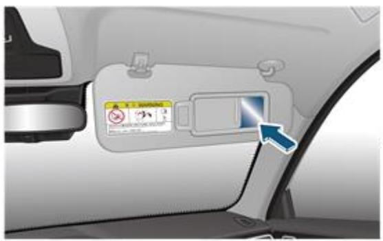
При использовании зеркала сдвиньте крышку зеркала влево.
