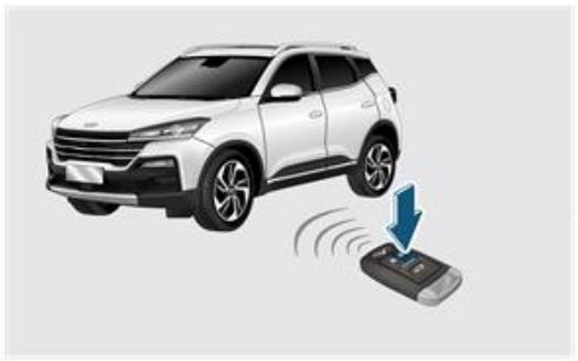
В пределах рабочего расстояния брелока питание всего автомобиля находится в состоянии «OFF», коротко нажмите кнопку разблокировки на брелке, все двери разблокируются, а указатель поворота мигнет 2 раза.
