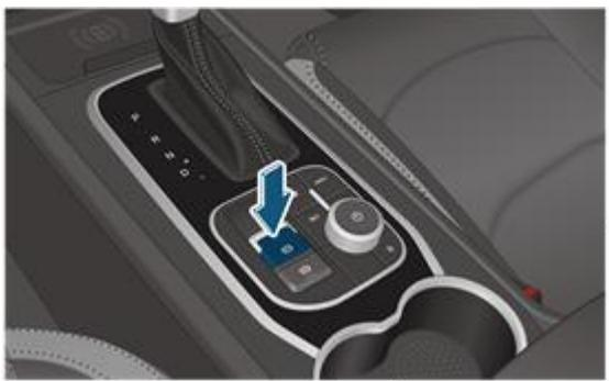
Когда источник питания всего автомобиля находится в состоянии «ON» и передача находится в положении «Р» или «N», нажмите на педаль тормоза, нажмите на электронную парковочную кнопку EPB, лампочка кнопки погаснет, а индикатор стояночного тормоза (P) на приборе погаснет, что указывает на то, что электронный стояночный тормоз разблокирован.
