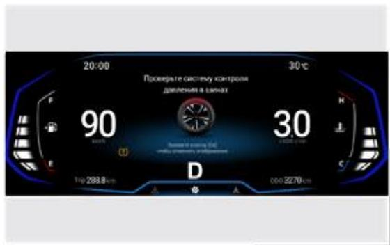
Когда давление в шинах слишком низкое, индикатор неисправности системы контроля давления в шинах
