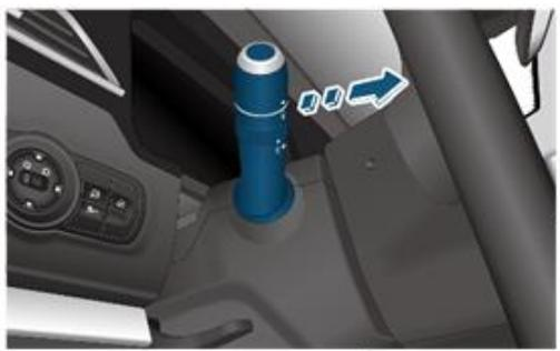
Потяните переключатель управления светом назад в крайнее положение рядом с рулевым колесом, загорится дальний свет, переключатель света автоматически вернется в положение после отпускания, и дальний свет погаснет. Непрерывно отступайте при обгоне, отпустите переключатель управления светом и отправьте сигнал обгона.
