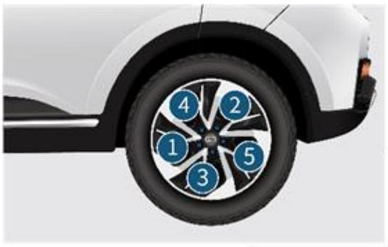
7. Опустите автомобиль, в порядке диагональных линий, показанных на рисунке, поочередно затяните болты.
