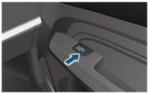
Электропитание всего автомобиля находится в состоянии «ON» (или переключено в состояние «OFF» в течение 2 мин, и две передние двери не открыты), и кнопка стеклоподъемника со стороны пассажира может работать.
