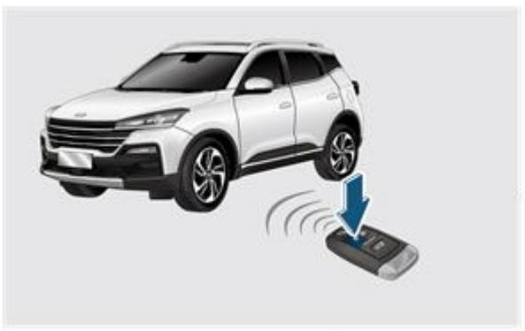
В пределах рабочего расстояния брелка, питание всего автомобиля находится в состоянии «OFF», а дверь закрыта (включая заднюю дверь), коротко нажмите кнопку фиксации на брелке, все двери заблокируются, указатель поворота мигнет 1 раз, а звуковой сигнал прозвучит 1 раз.
