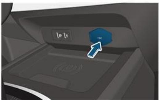
Когда источник питания всего автомобиля находится в положении «ON» или «ACC», откройте крышку резервного питания, подключите зарядное оборудование и используйте.
