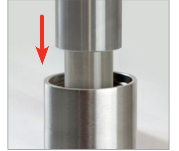
4. Veri kaydediciyi ve kapağı tekrar bariyer gövdesinin içine doğru kaydırın ve kapağı sıkıca vidalayın.
