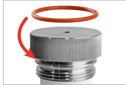
2. O-Ring'i uç kapağının üzerinden gerdirerek geçirin, böylece tırtıllı omzun hemen altındaki yuvaya oturmasını sağlayın.
