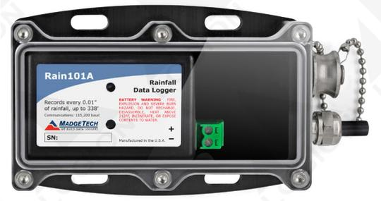
Rain101A – это полная система для точного измерения и записи дождевых осадков на протяжении длительных периодов времени. В комплекте поставляется регистратор данных Event101A, водонепроницаемая оболочка, дождемер с наклонным ведром, 50 футов кабеля и интерфейсный кабель IFC200 с программным пакетом.
