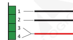
Для 2-проводных зонды RTD соедините входы 3 и 4 вместе, а также входы 1 и 2 вместе, затем подключите проводники RTD к входам 2 и 3.
