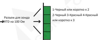
Для 3-проводных зонды RTD соедините входы 3 и 4 вместе, затем подключите проводники к входам 1, 2 и 3.
