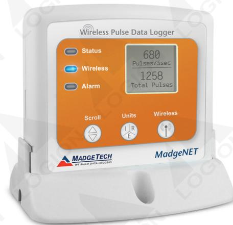
RFPulse2000A — это беспроводной регистратор данных, который фиксирует выходные импульсные сигналы от различных датчиков, таких как расходомеры и анемометры. При запуске регистратор данных выполняет выборку с частотой 100 Гц и с указанной пользователем скоростью чтения, записывая общее количество импульсов из выборки в память.
